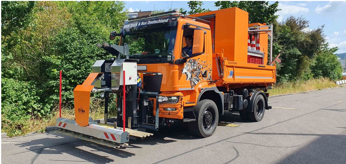
Abb. 1: RAPTOR 2M an einem MAN TGE-Trägerfahrzeug
